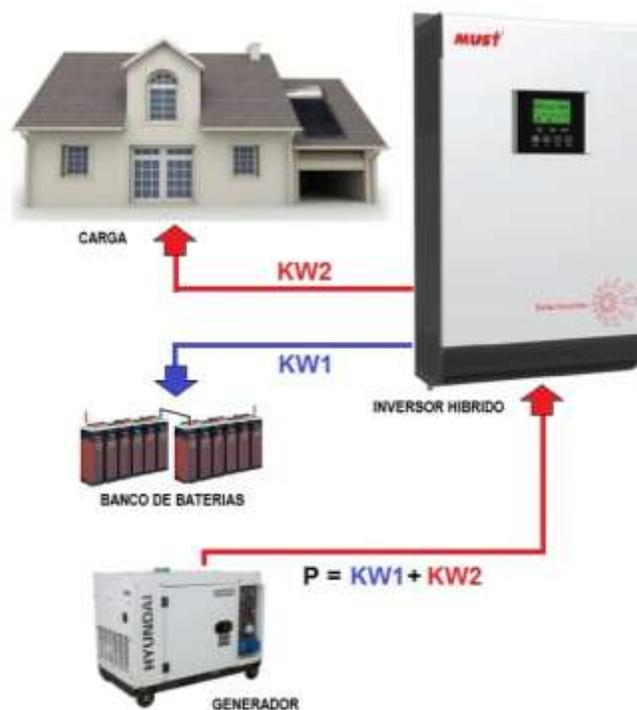
Figura 3. Inversor cargador
