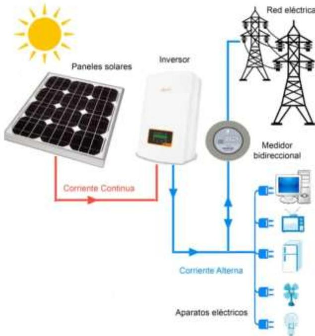
Figura 4 Inversor de conexión a red
